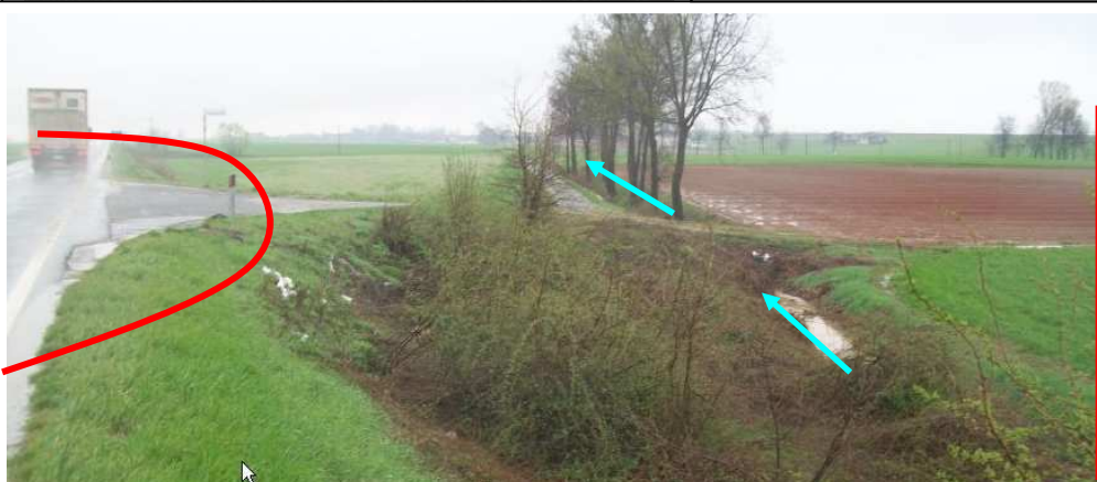
FOTO 4 A VALLE DELLA ROTONDA IN PROGETTO (LINEA ROSSA) LA ROTONDA IN PROGETTO NON SI MODIFICA ALLO STATO ATTUALE IL DRENAGGIO SUPERFICIALE
